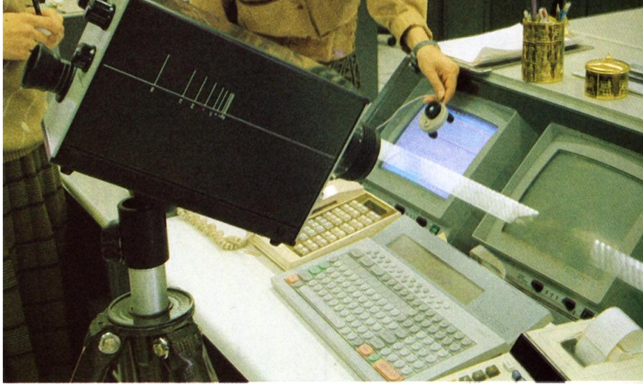
Parazit görüntü ışıklılığının ölçülmesi
